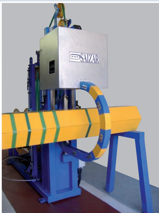
Flejadora para el flejado transversal de paquetes con fleje de poliéster de 32mm.
