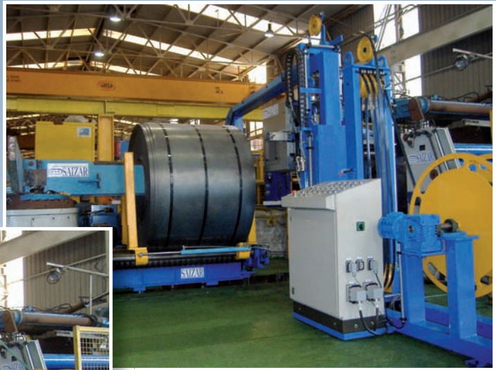
Bobina flejada circunferencialmente por la flejadora automática, con fleje de acero de 32mm.
