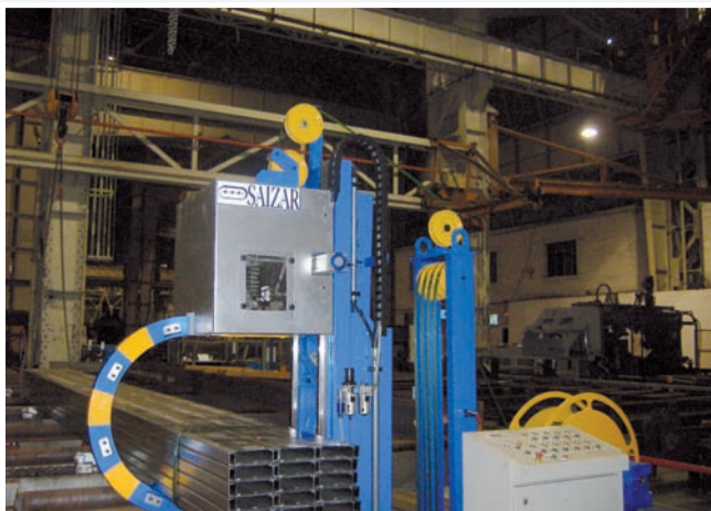
Flejadora para el flejado transversal de paquetes de tubos con fleje de acero de 25mm.
