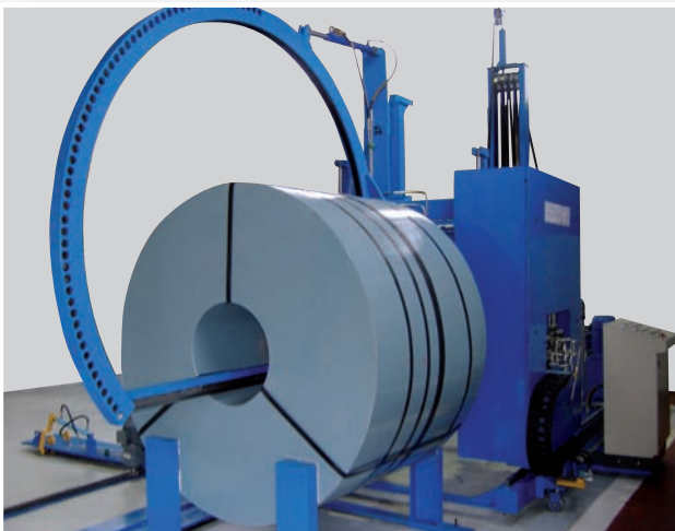
Flejadora en posición de flejado radial
