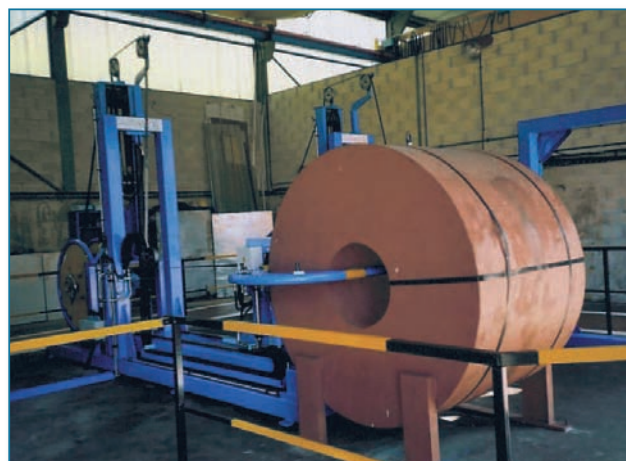
• Cabezal en posición de flejado • Strap head at strapping position
